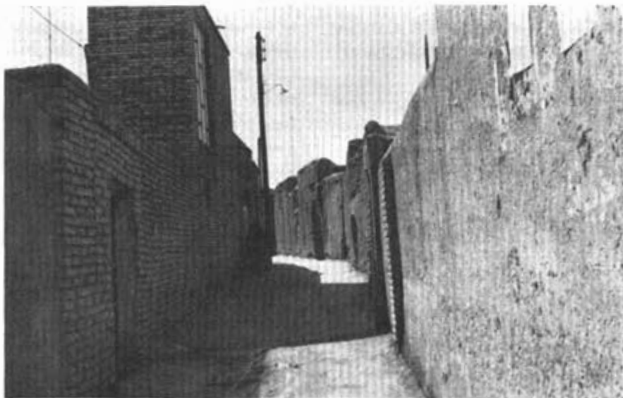
تصویر ۶- معابر شهر زواره. ایجاد جریان هوا در کوچه با استفاده از اختلاف دمای سایه و آفتاب برای مواقعی که امکان استفاده از باد مفید وجود ندارد.
